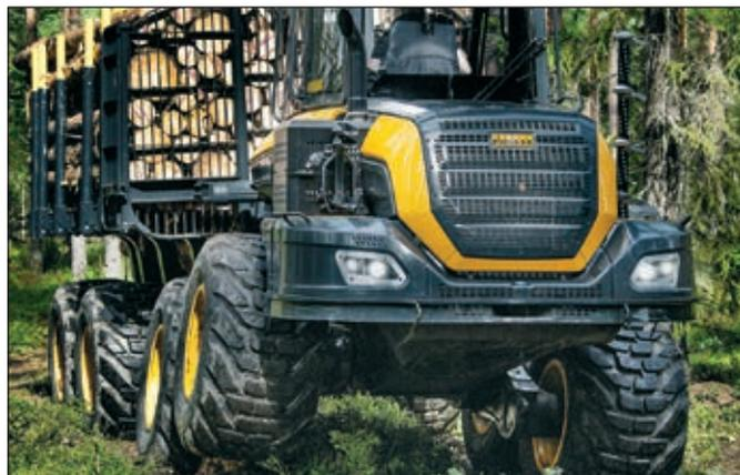
PONSSE ActiveFrame — это новая система подвески кабины для 8-колесных машин. Простая и функциональная конструкция системы эффективно и незаметно смягчает воздействие боковых толчков на оператора. Опция ActiveFrame доступна для установки на PONSSE Ergo, Buffalo, Elephant и ElephantKing. Максимальный угол выравнивания на машинах ElephantKing и Elephant составляет 6 градусов, а на Ergo и Buffalo — 7 градусов.
